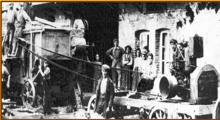
De la gauche vers la droite : la batteuse, la courroie puis le moteur suédois. Photo prise devant la forge du maréchal-ferrant « Julot » (voir bulletin numéro 1)
